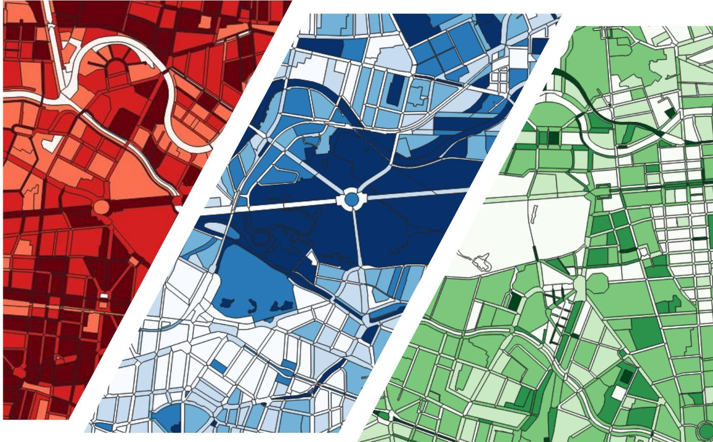
Die drei Komponenten des Wasserhaushalts: Oberflächenabfluss, Verdunstung und Versickerung in mm/a
