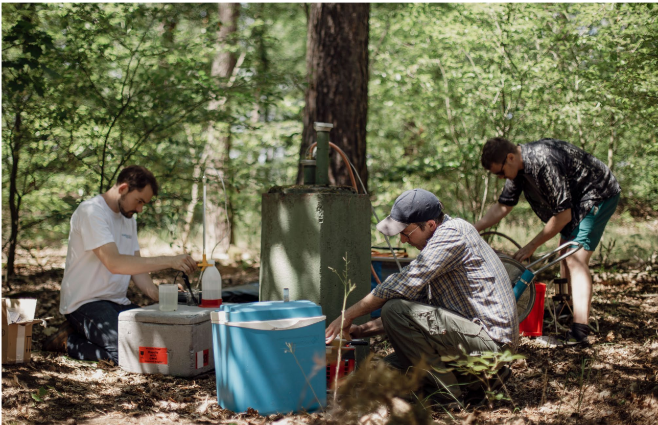
Die Grundwasserprobenahme an einer Messstelle
