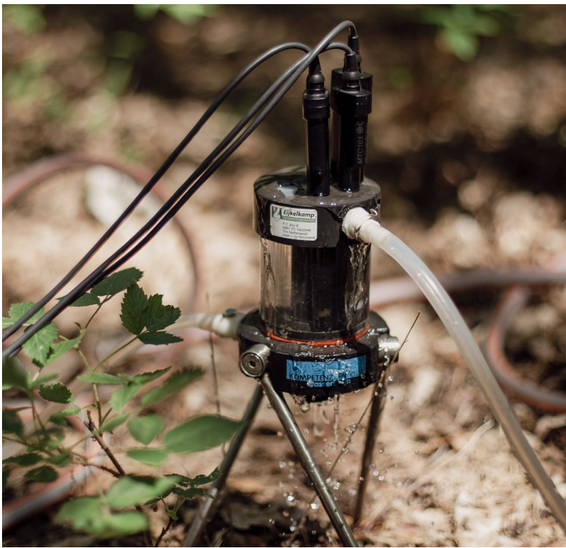
Während der Grundwasserprobenahme werden physikochemische Parameter (pH, Temperatur, Leitfähigkeit, Sauerstoff, Redoxspannung) in einer Durchflusszelle gemessen.
