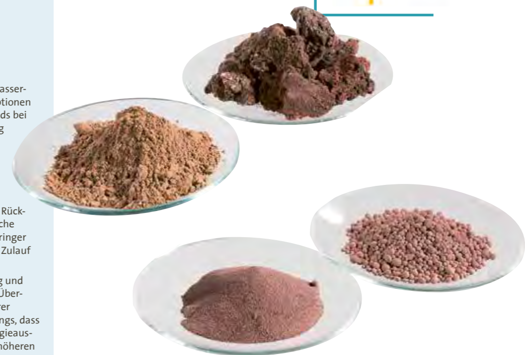
Zwischenprodukte bei der Herstellung von granuliertem Phosphor-Recyclingprodukten aus Klärschlammmasche
