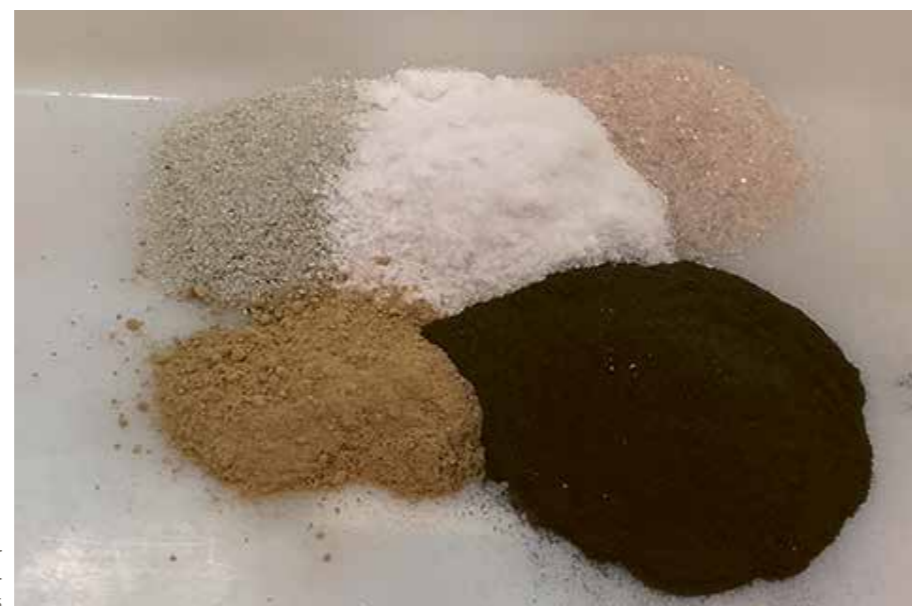
Sand und Tiermehlaschen vor der Vermischung und Herstellung eines NPK-Düngers
