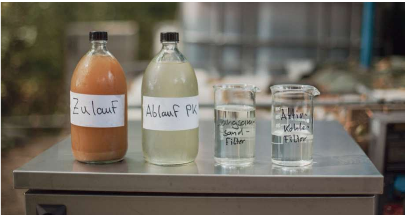
Die sichtbaren Veränderungen der Wasserqualität durch die verschiedenen Behandlungsstufen im Rahmen des DeWaResT-Projekts.
