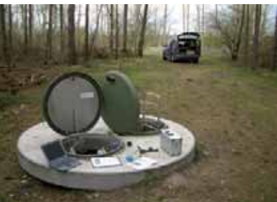
Auslesen von Messdaten an einem Brunnen Data recording for well monitoring
