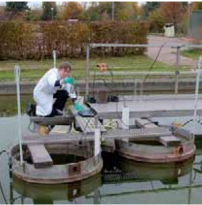
Laborversuche zur Glyphosat Elimination bei der Untergrundpassage Sampling the Enclosures for Glyphosate Analysis
