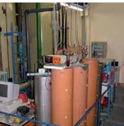
Bodensäulenversuch in Berlin-Marienfelde, UBA Technical Scale Column experiments at UBA
