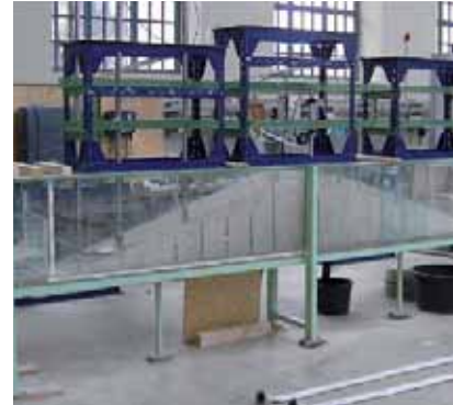
Test von Online-Sensoren für die kontinuierliche Messung von Gewässergüteparametern Testing of online sensors for continuous water quality measurement (KWB)
