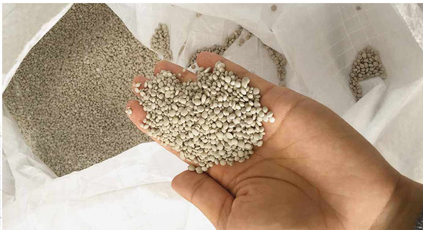
Rückgewonnenes Struvit aus der Kläranlage Amersfoort
