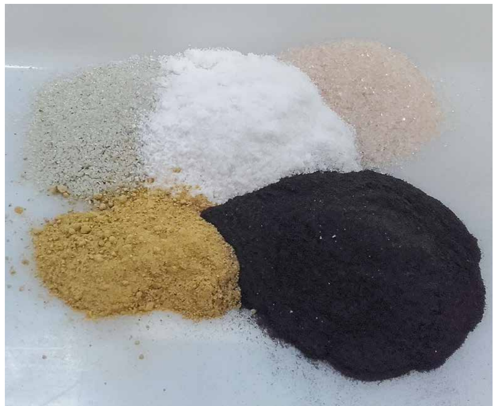
Sand und Tiermehlaschen vor der Vermischung und Herstellung eines NPK-Düngers
