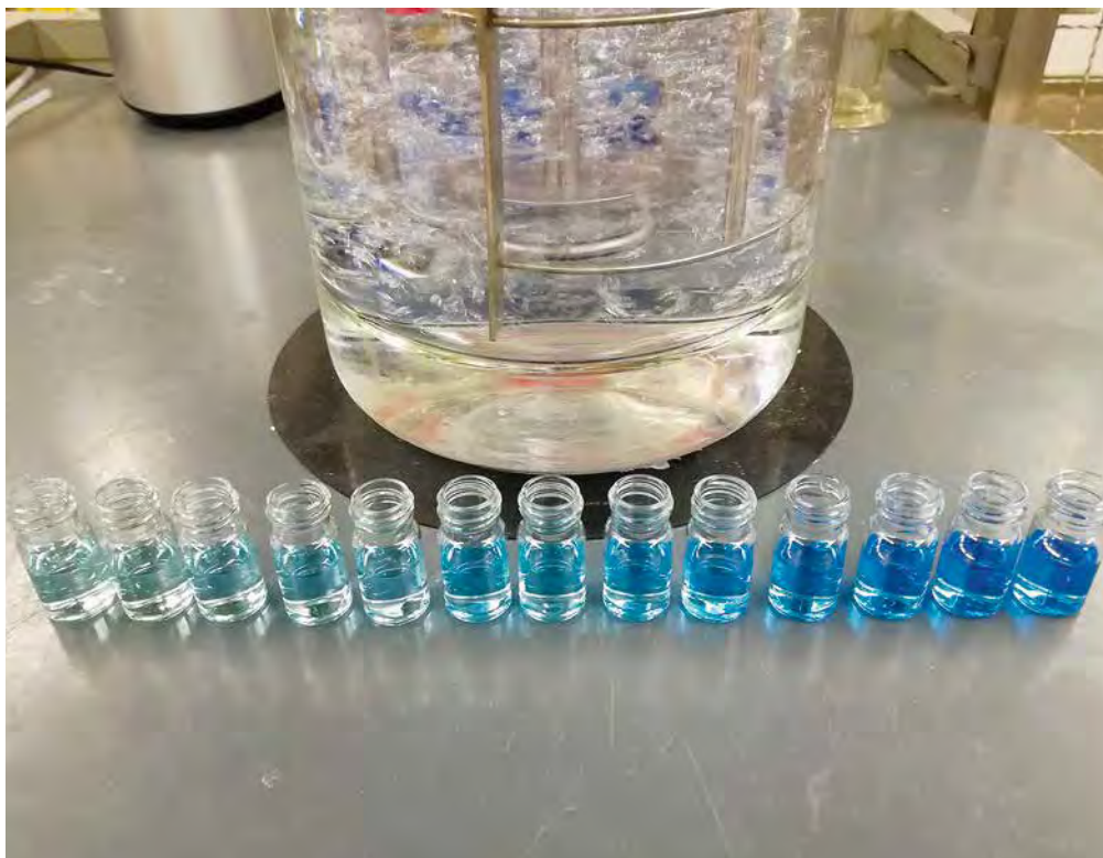
Nutzung der Entfärbung von Indigoblau zur Quantifizierung von gelöstem Ozon
