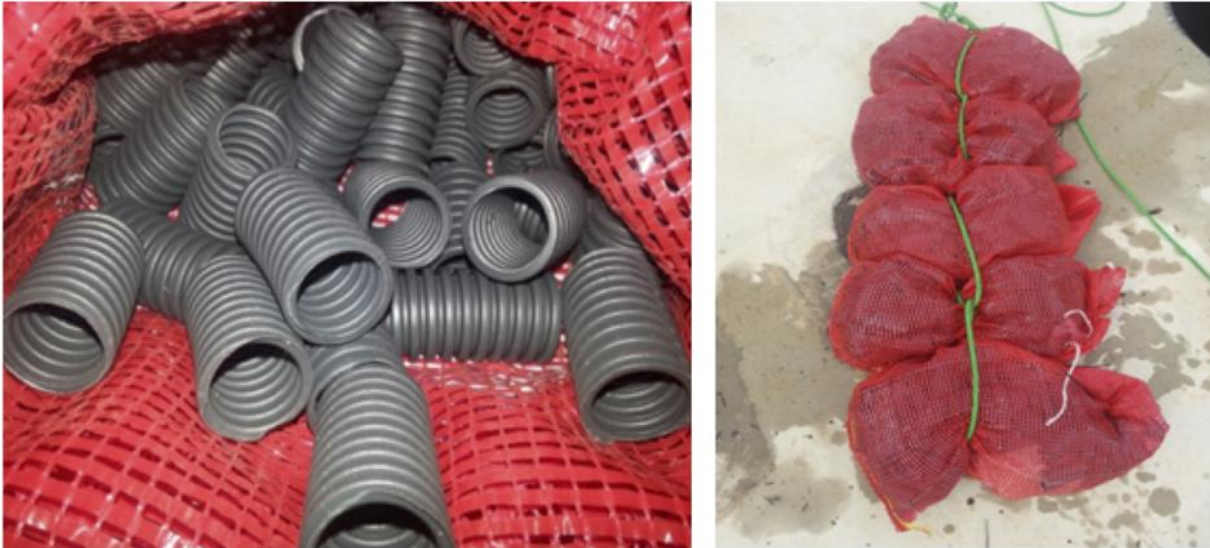
Abbildung 9 Aufwuchskörper zur Erhöhung der Feststoffkonzentration (Nivala et al. 2019)
