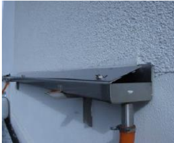
Abbildung 26: Fassadenrinne für Probefläche 1 – 4 der Fassadenuntersuchungen.
