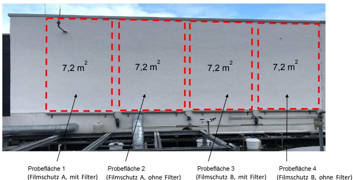
Abbildung 1: Versuchsfelder für die Pilotanwendung des algizidfreien Fassadensystems und der Regenwasserminifilter.
