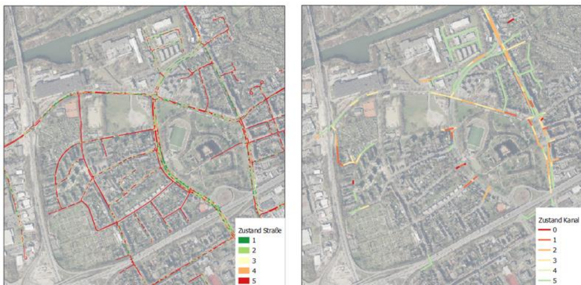
Abbildung 50 Übersicht der Straßenbau und Kanalzustandsklassen für das Quartier Baukau
