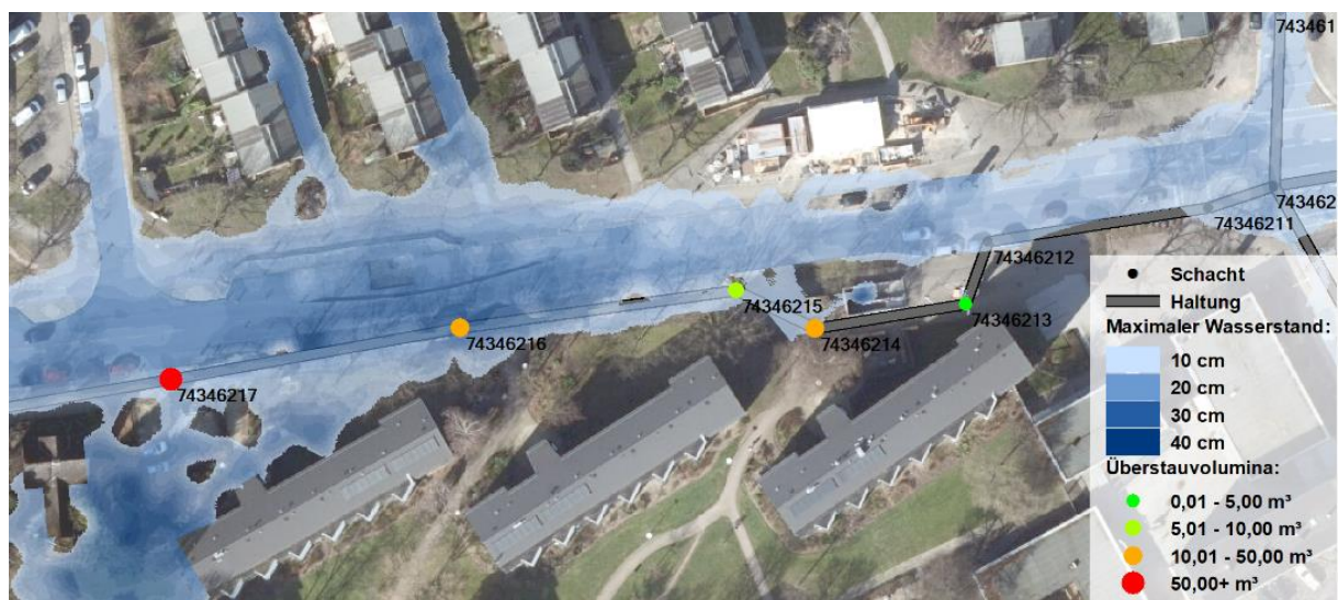
Abbildung 8 Ergebnis einer 1D/2D-gekoppelten Simulation (Quelle: itwh GmbH)
