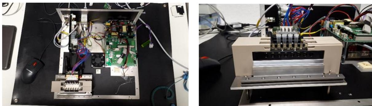
Abbildung 1.3-43: Funktionsmustersaufbau zur Testung der qPCR. Links: Labormustersaufbau von oben, rechts: modifizierter PCR-Block mit optischen Fenstern für die Detektion des Fluoreszenzsignals.
