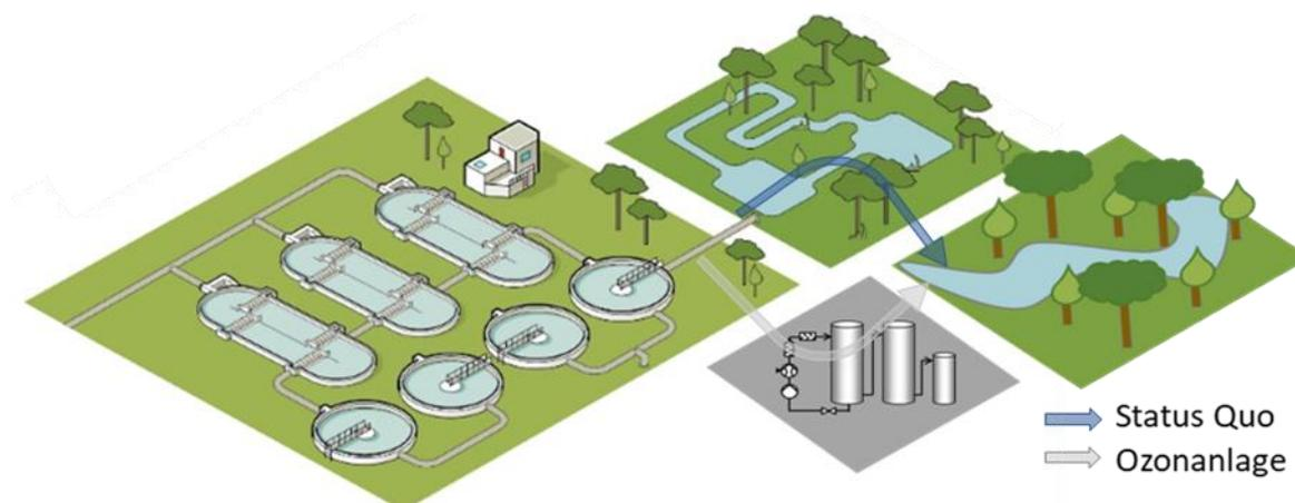
Abbildung 1.4-2: Status Quo: in Braunschweig durchfließt der Kläranlagenablauf ein Rieselfeld, bevor er in die Oker gelangt (blauer Pfeil). Im Vergleichsszenario wird das Rieselfeld durch eine Ozonanlage ersetzt (grauer Pfeil)
