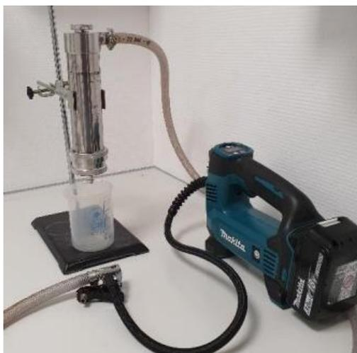
Abbildung 1.3-42: Filterkartuschen (links) und Druckluftkompressor (rechts) zur mobilen Filtration von Wasserproben.
