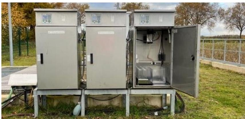
Abbildung 1.1-23: Automatische Probenahmegeräte der Firma WaterSam für die drei Abläufe des RBF<sup>plus</sup> in Rheinbach. Im geöffneten Probenahmegerät rechts sind die Dosiervorrichtung im gekühlten Innenraum sowie die desinfizierten Probensammelgefäße aus Glas zu sehen.
