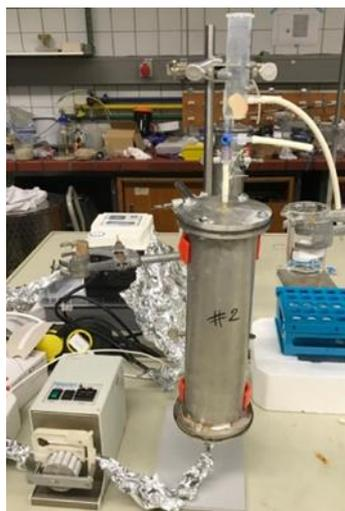
Abbildung 1.3-14: Schema des Aufbaus einer der beiden Bodensäulen (links), Foto des Aufbaus (rechts).
