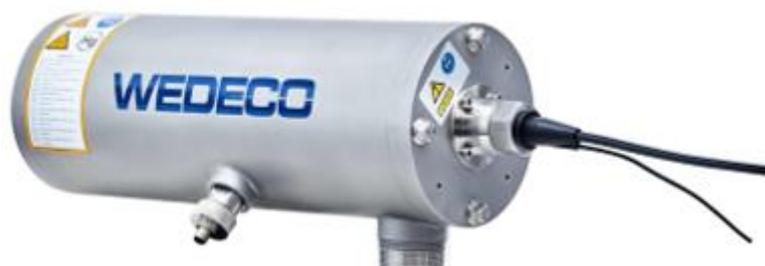
Abbildung 1.1-20: UV Reaktor Spektron 6. Sichtbar sind der Anschlussflansch für die UV-Sonde in der Mitte der Reaktorlänge, die elektrischen Versorgungsanschlüsse rechts im Mittelpunkt der Endplatte sowie der Hydraulische Zugang (unten rechts im Bild).
