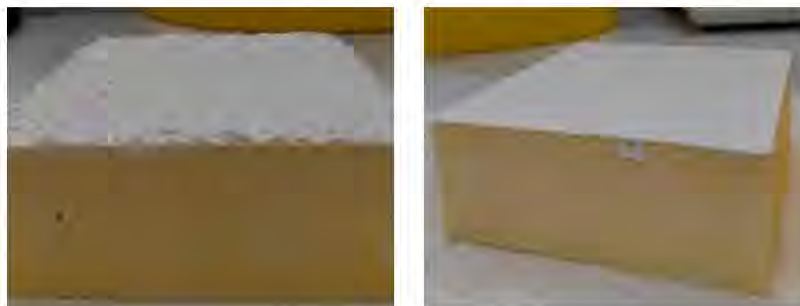
Abbildung 29: Prüfkörper beschichtet mit Putz (links) und doppeltem Farbanstrich (rechts)
