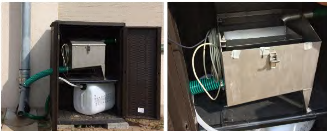
Abbildung 8: Realisierung der Beprobung von Dachablauf mittels Kippwaage im Testgebiet A
