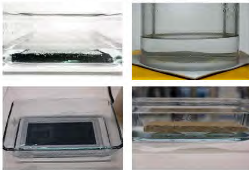
Abbildung 30: Prüfkörper im DSLT: Bitumenbahn (links oben), PE-beschichtetes Metallblech (links unten), FPO-Kunststoffdichtungsbahn (rechts oben) und Pflasterstein (rechts unten)
