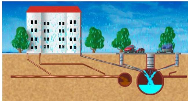
Abbildung 1-3: Prinzipskizze Trennsystem
