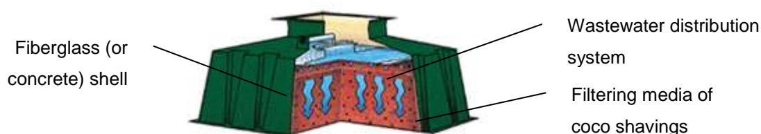
Abbildung 27: Schematische Prinzipskizze des Ecoflex™ Biofilters
