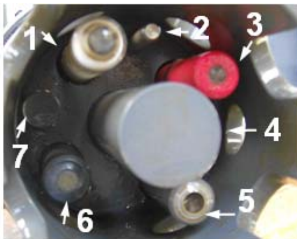
Abb. 8: Sensorkopf einer ISE-Sonde [Bild: FG Siedlungswasserwirtschaft]
