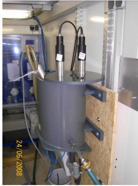
Abb. 58: Beispiel für einen möglichen Aufbau eines Bypassmesssystems, links ein Durchflussmesstopf, rechts ein Rohrsystem mit Stutzen zur Installation der Sonden [Bilder: FG Siedlungswasserwirtschaft]
