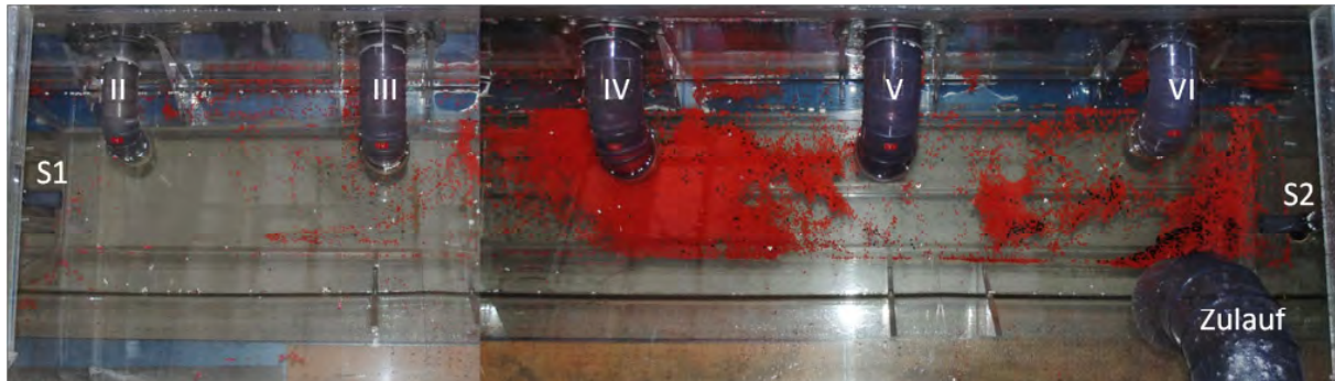
Abbildung 3: Sedimentationskarte des Modellversuchs am Originalbauwerk im Spülbetrieb
