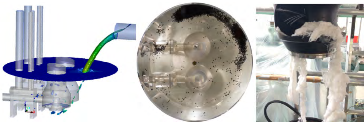
Abbildung 2: Untersuchung von Lufteintrag, Sedimentation und Verstopfungsverhalten an Schachtpumpwerken
