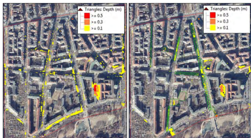
Abbildung 4: Status Quo- (links) und Maßnahmenzenario (rechts), dargestellt sind maximale Wasserstände
