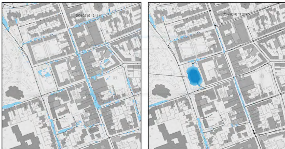
Abbildung 2: Simulation für die Mitbenutzung eines Parkplatzes zur Entlastung der Herner Fußgängerzone bei Starkregen [KlimaNet 2010 in (Benden 2014)]
