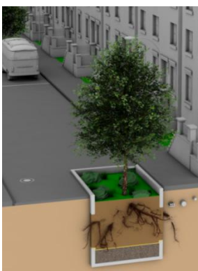
Schematisches Bild einer Baumrigole (Abbildung: IPS)
