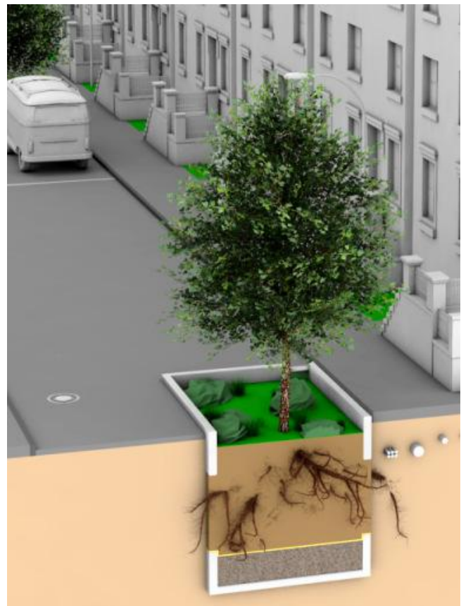
Schema einer Baum-Rigole (Quelle: Sieker)
